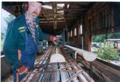
51. Ny spon: Grantrea vart utvalgt på rot i sevjetida. Trea hadde vakse svært seint. Sponen vart saga radialt.
